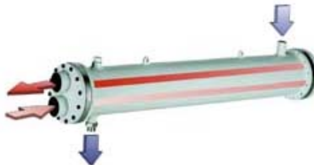
Fig. 2.71. Schema de curgere într-un condensator multitubular orizontal
