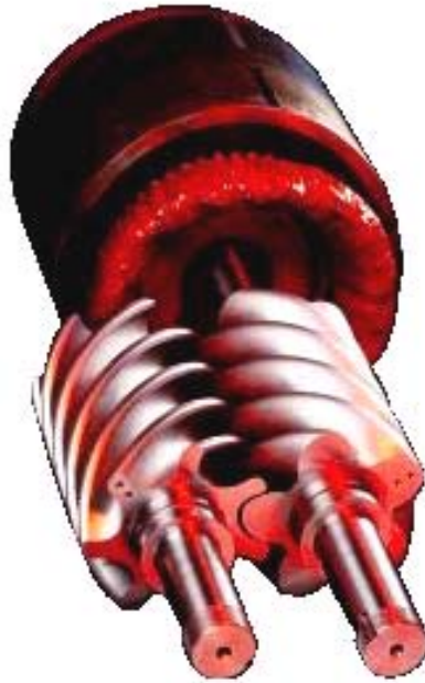
Fig. 1.15. Rotor tată cu 5 lobi și rotor mamă cu 7 canale
