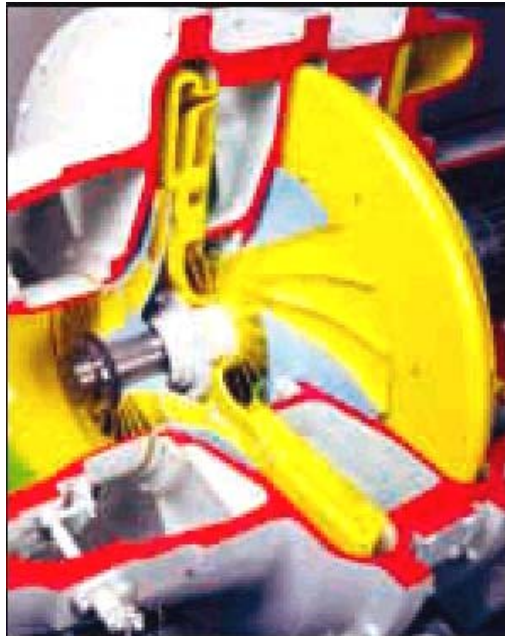
Fig. 1.27. Rotorul unui compresor centrifugal
