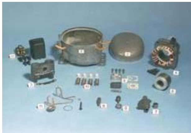
Fig. 1.10. Elemente componente ale compresoarelor ermetice
