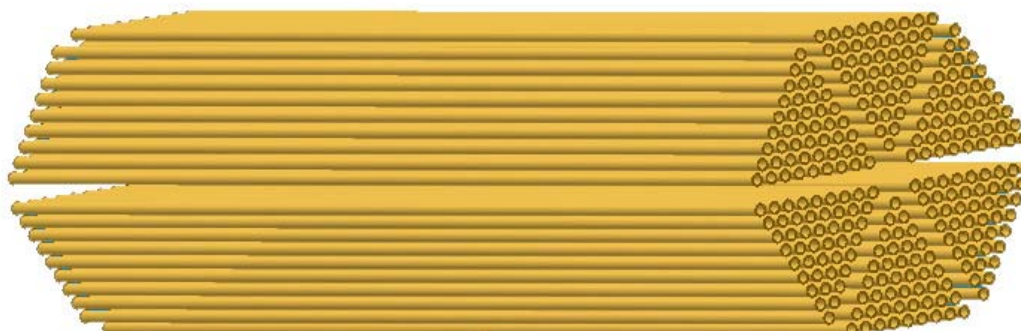
Fig. 12.13. Țevile pentru apă ale condensatorului
