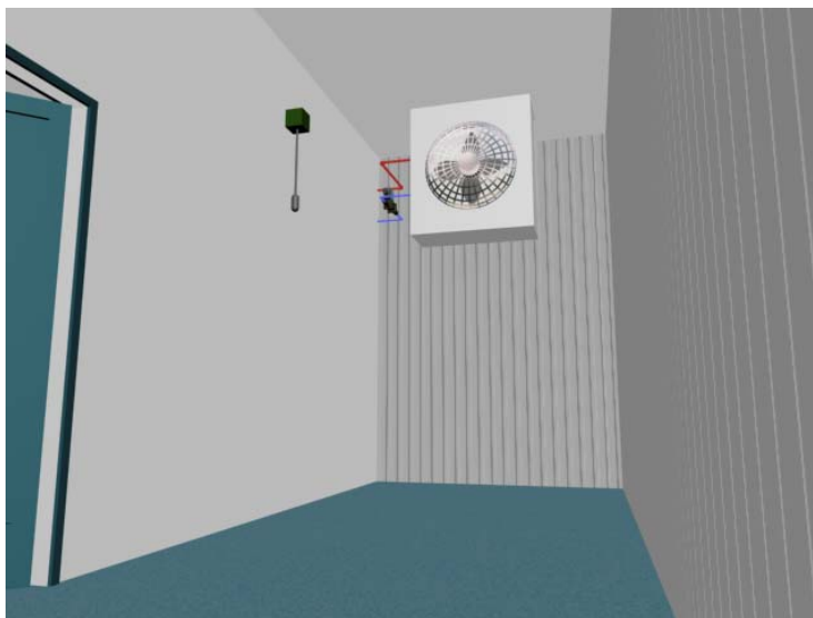
Fig. 8.25 Amplasarea vaporizatorului - depozit refrigerare mezeluri
