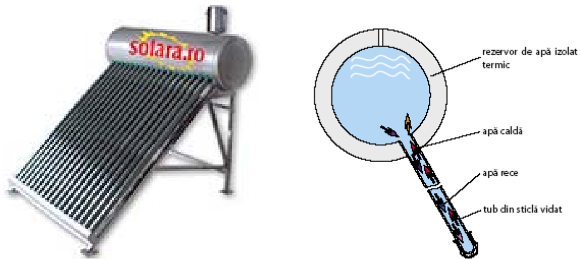
Fig.2.1.3 Colectoar solar cu rezervor integrat nepresurizat
