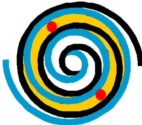
Fig. 1. Poziția racordurilor de injecție a vaporilor reci la presiune intermediară, în timpul procesului de comprimare
