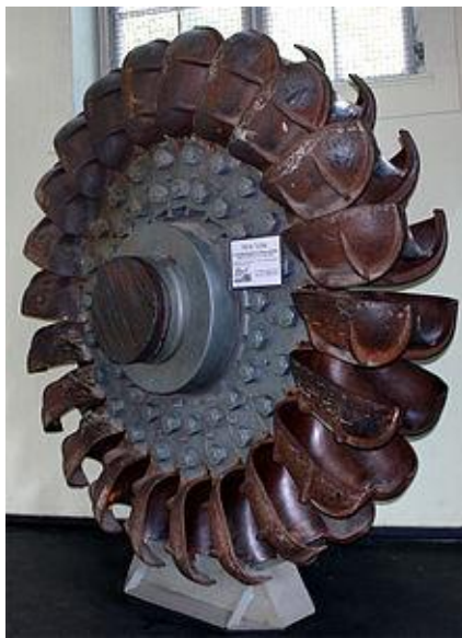
Figura 10.4. Reprezentarea schematică a unei turbine Pelton
