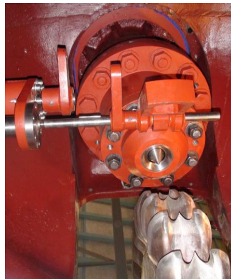
Figura 10.4. Reprezentarea schematică a unei turbine Pelton
