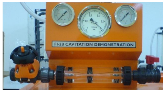
Figura 5.3. Modul pentru demonstrarea cavitației
