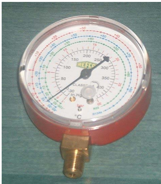
Fig. 16. Manometru frigorific de refulare
