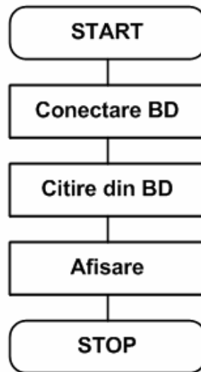
Fig. 21. Schema de principiu a programului de citire a parametrilor din baza de date și afișare a acestora pe panoul virtual de monitorizare
