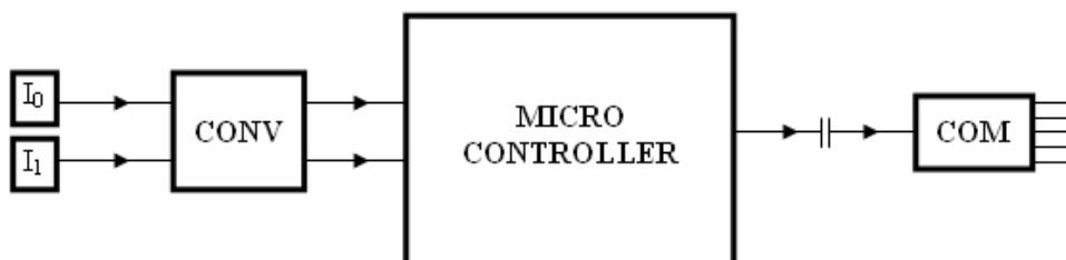
Fig. 29. Schema de principiu a sistemului de achiziție a datelor, cu microcontroler
