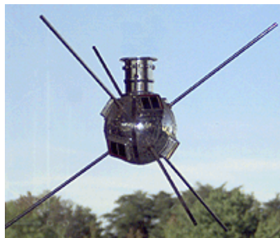
Fig. 5.7. Primele panouri solare, montate pe Vanguard I
