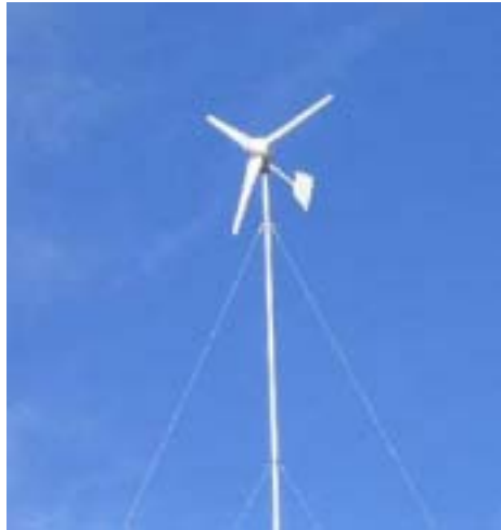
Fig. 6.2. Turbină eoliană de putere redusă
