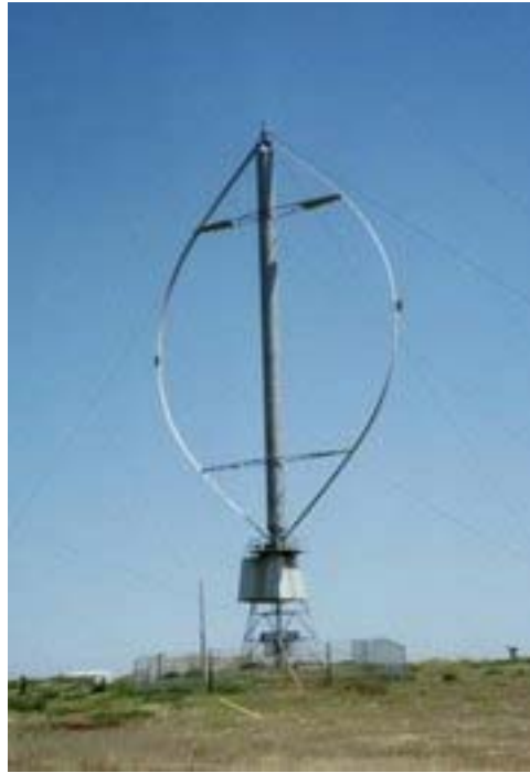
Fig. 6.4. Turbine eoliene verticale
