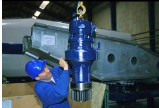
Fig. 6.22. Motorul sistemului de pivotare www.windpower.org
