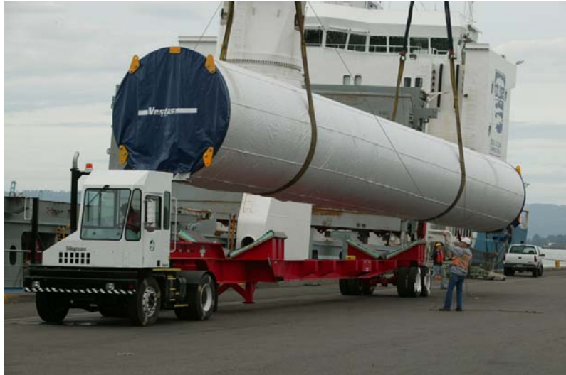
Fig. 6.14. Tronson al unui pilon de turbină eoliană
