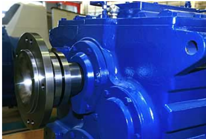
Fig. 6.20. Arbore de turație ridicată www.windpower.org
