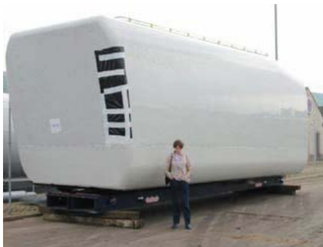
Fig. 6.11. Nacela unei turbile eoliene de 2 MW
