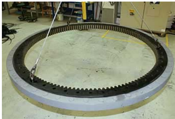
Fig. 6.23. Elementul de transmisie al sistemului de pivotare www.windpower.org
