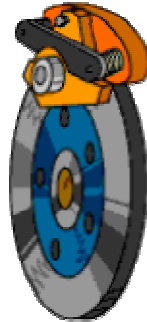
Fig. 6.18. Principiul de funcționare al frânei www.windpower.org
