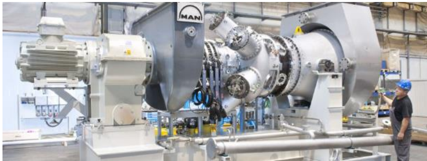
Turbină cu gaze cuplată cu generatorul electric
