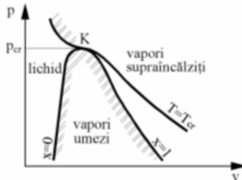
Curbele limită și domeniile de lichid și vapori în diagrama p-v.
