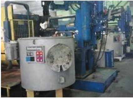
Cuptoare pentru menținerea aluminiului topit, înainte de turnare
