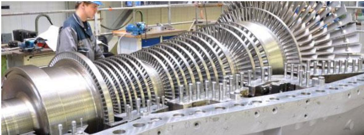
Imagine a rotorului și paletelor unei turbine de abur MAN
