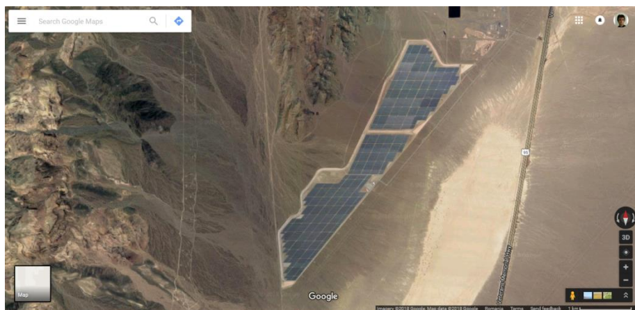
Vedere aeriană a site-ului centralei fotovoltaice Copper Mountain Solar 3 CMS 1: 58 MW (2010 – era cea mai mare centrală fotovoltaică); CMS 2: 92 MW (2012); CMS 2 extensie: 58 MW (2015); CMS 3: 250 MW (2015); CMS 4: 94 MW (2016) Total: 552 MW
