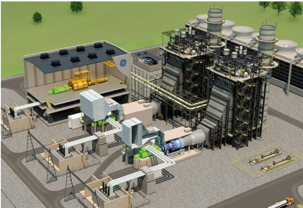
Instalație care funcționează după ciclul combinat bazat pe turbine cu gaze
