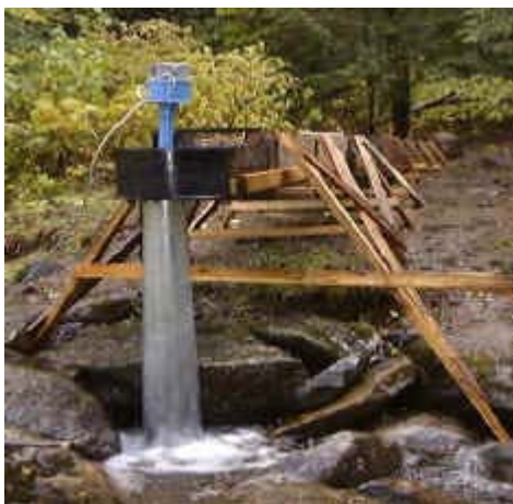
Turbina hidraulica de 200 W, de tip Power Pal
