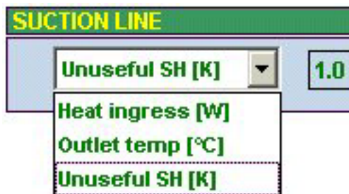
Introducerea supraîncălzirii pe conducta de aspirație
